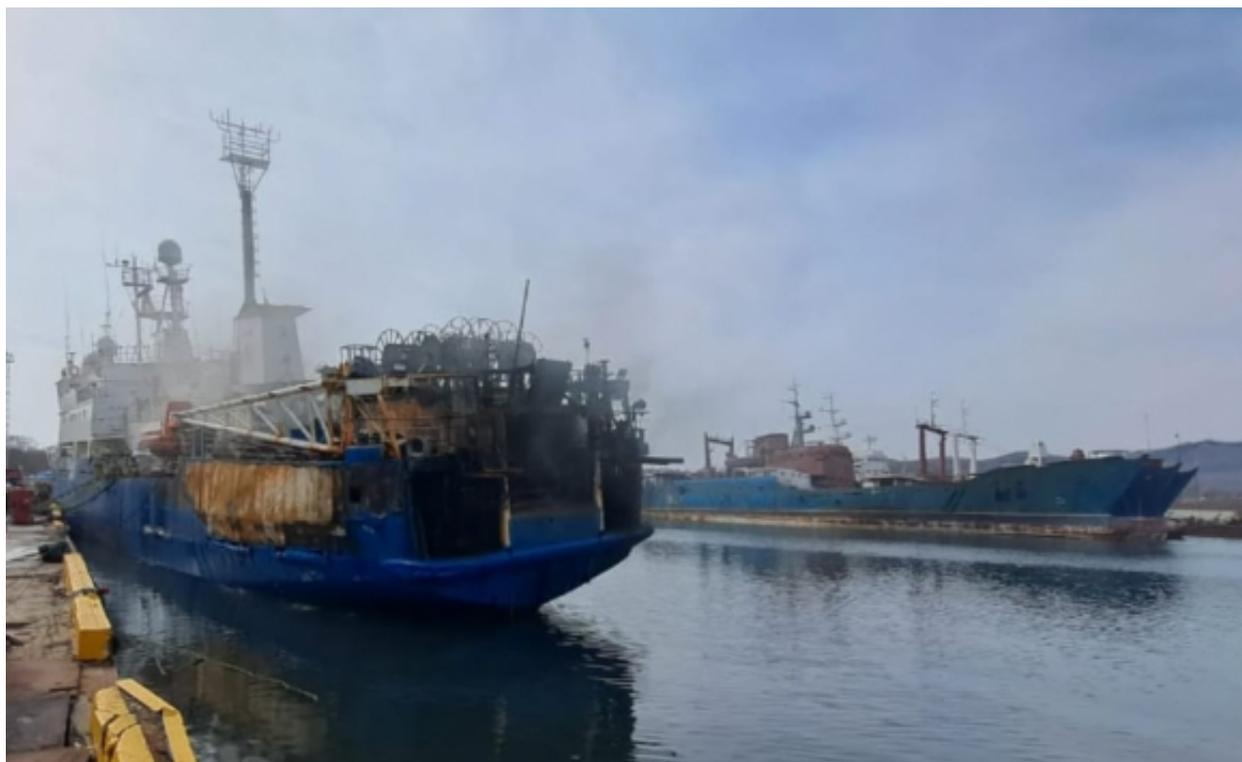
По предварительным данным, 16 марта 2024 года на борту НИС «Геолог Дмитрий Наливкин», пришвартованном к причалу № 9 ПАО "Ливадийский судоремонтный завод" в городе Находка, произошло возгорание в кормовой части судна вследствие нарушения правил ведения сварочных и ремонтных работ. Пострадавших нет.
