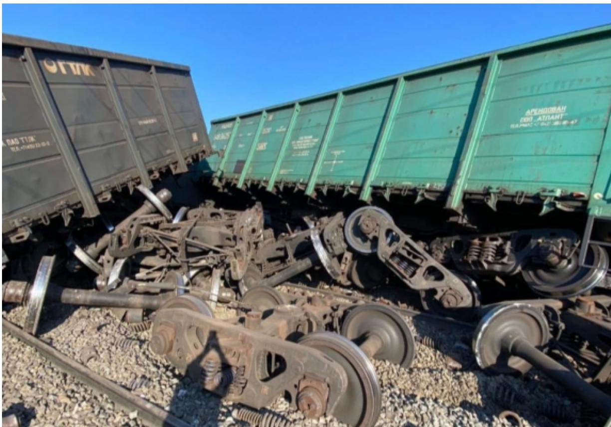
Установлено, что утром 18 марта 2024 года на 7234 км перегона Бамовская-Горелый Забайкальской железной дороги в результате столкновения грузового поезда с легковым автомобилем произошел сход 20 порожних вагонов. Водитель автомобиля госпитализирован в медицинское учреждение. Размер ущерба устанавливается.
